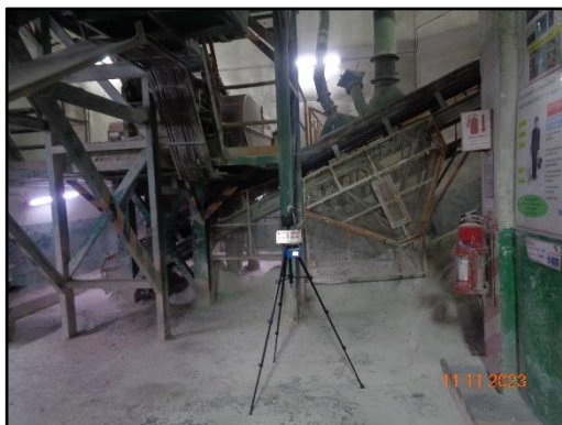
ภาพที่ 3.55 การตรวจวัดฝุ่นละอองในสถานที่ทำงานบริเวณเครื่องย่อยหินปูน
