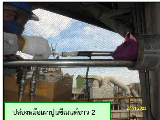
ภาพที่ 3.3 การตรวจวัด \text{NO}_x as \text{NO}_2 จากปล่องหม้อเผาปูนซีเมนต์ขาว 1 และ 2
