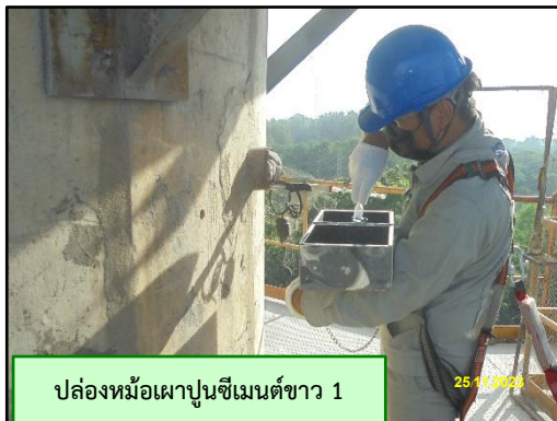
ภาพที่ 3.3 การตรวจวัด \text{NO}_x as \text{NO}_2 จากปล่องหม้อเผาปูนซีเมนต์ขาว 1 และ 2
